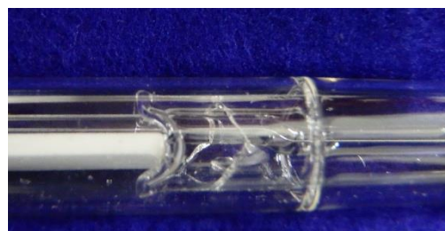
例) ガラス破損
